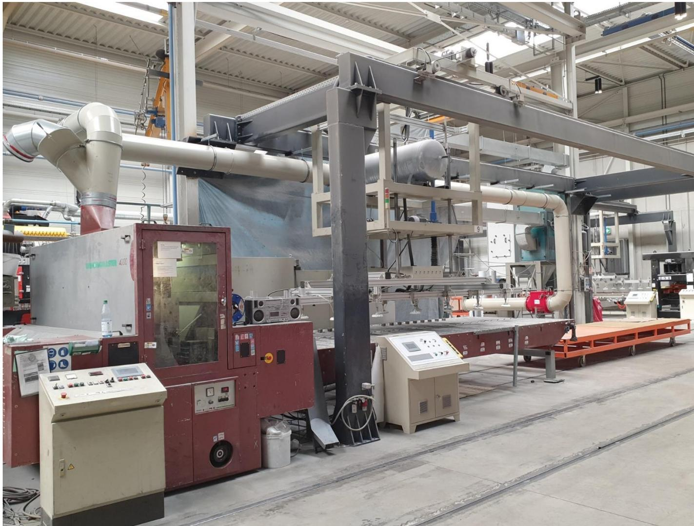
Spannring-Rohrleitung mit Explosions-Rückschlagklappe (passiver Explosionsschutz)
