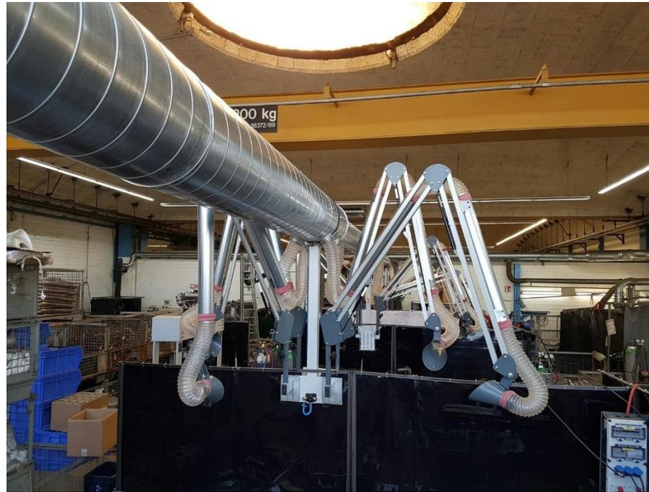
**Entstauber aero4 an Schleifmaschinen und Schweißrauchabsaugung**
